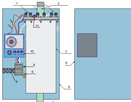
Теплообменник представляет собой цилиндрический сосуд с укреплёнными в нём электронагревателями (ТЭНами), имеющий два отверстия: для подвода и отвода теплоносителя.
